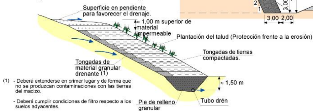
Figura 39: Soluciones empleadas para hacer frente a deslizamientos superficiales en desmontes arcillo -margosos andaluces (tomada de Atienza, M. & Ortuño, L. (1997))
